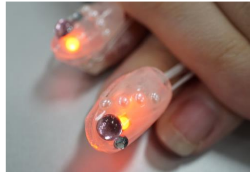
図4. 付け爪型ウェアラブル端末の実装
