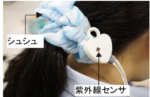
図3. 紫外線センサを組み込んだチャーム
